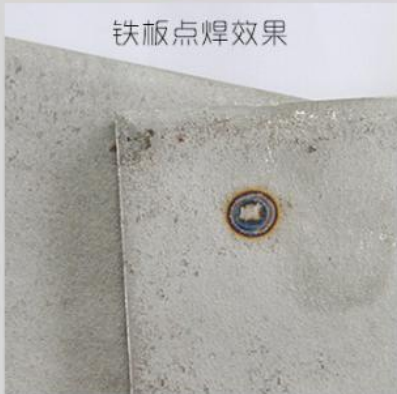
2mm不锈钢板点焊效果
